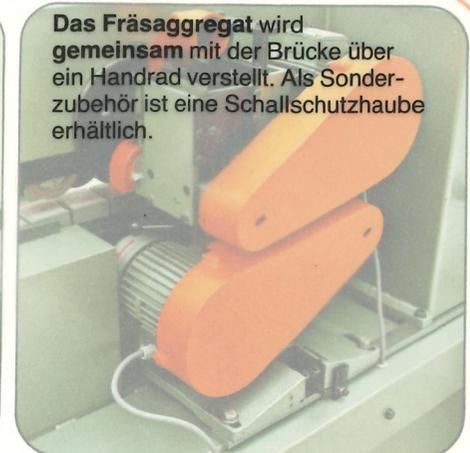
Das Fräsaggregat wird gemeinsam mit der Brücke über ein Handrad verstellt. Als Sonderzubehör ist eine Schallschutzhaube erhältlich.
