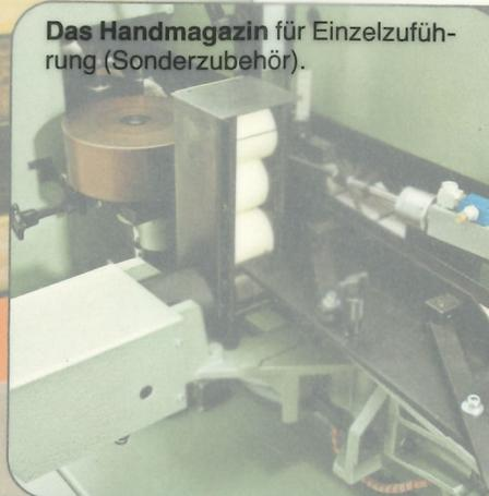
Das Handmagazin für Einzelzuführung (Sonderzubehör).
