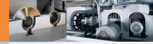
Schnell und einfach können das Vorritz- und das Hauptsägeblatt gewechselt werden. Mit der Funktion »Eichen Sägeblatt« lässt sich die Schnittvermaßung auf 1/100 genau von der Steuerung aus justieren. Bei einem Servicebedarf kann das Sägeaggregat aus dem Maschinenständer ausgefahren werden.
