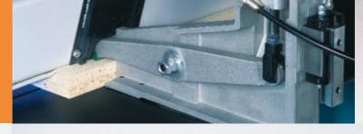
Mit der richtigen Einstellung zur Arbeit: Die Werkstückspannzangen in schwimmender Ausführung gleichen die Spannungen innerhalb der Plattenpakete nach oben aus. Die Restschnitteinrichtung sorgt für Aufteilungen ohne Restmaß.
