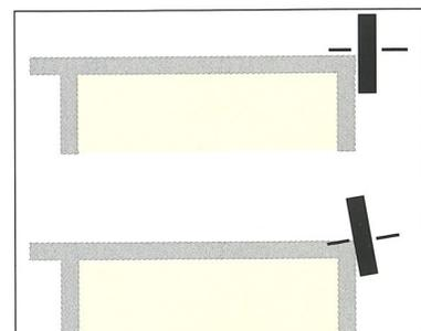
Selbst die Umstellung von Gerade- auf Fasekappen erfolgt auf Knopfdruck direkt vom Bedienpult aus.
