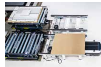
Die Übergabestation mit Hubtisch hebt einen Materialstapel soweit an, dass sich die oberste Lage in der idealen Abnahmehöhe für den FEEDBOT befindet.
