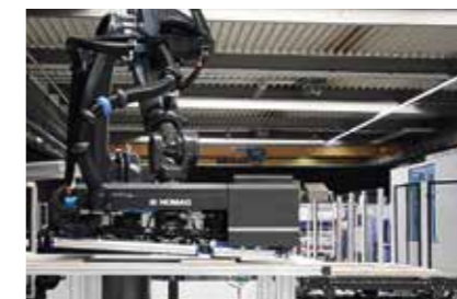
Auf dem Sortierplatz am Einlauf der Kantenanleimmaschine werden Werkstücke zwischengelagert, bis sie ideal in das Stapelbild passen, das vom Stapelroboter nach einem Bearbeitungslauf gebildet wird.
