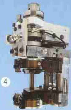
Getastetes Bündigfräsaggregat benutzt Antrieb, C-Achse und Pneumatik
