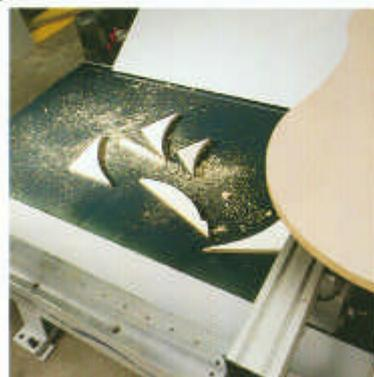
Reststückeentsorgung über Späne-transportband
