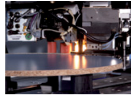
Kanten Anleimen mit dem powerEdge Aggregat
