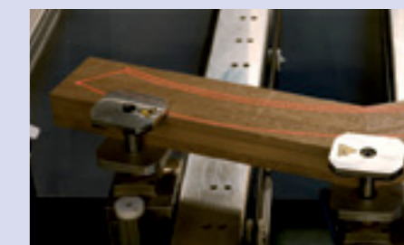
Laserprojektion der Spannmittel und der Werkstückkontur für optimale Ausnutzung und einfaches Auflegen von Rohteilen, die nicht an den Anschlängen ausgerichtet werden können.
