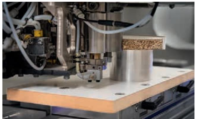
360° edge gluing with the powerEdge Pro Duo edge banding unit
