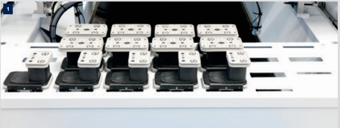
Odkládací místo pro přísavky – snadné a rychlé úložné místo
