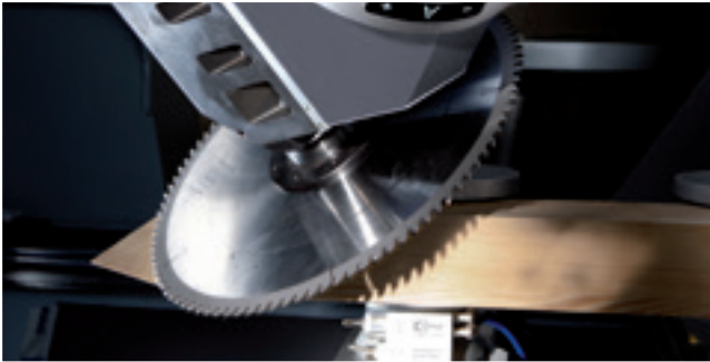
Úhlový řez s velkou hloubkou (kotouč o průměru až 350mm)
