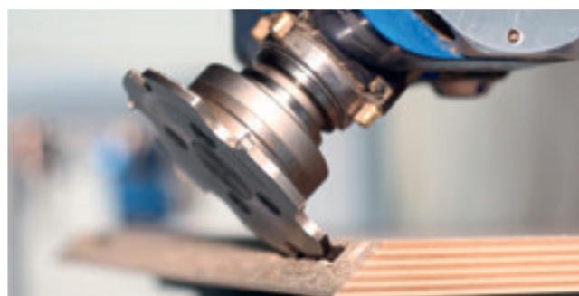
Vyfrézování otvoru pro spojovací kování
