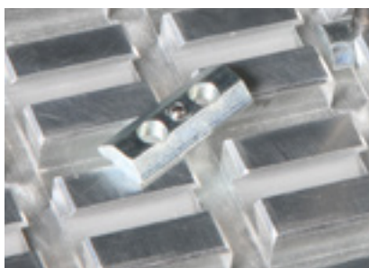
Vodící matice se závitem pro upnutí v trapézových drážkách dovoluje upnout jakýkoliv tvar.
