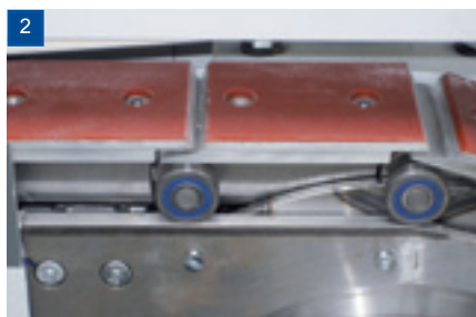
Rollende Kette – optimal bei hohen Leistungen
