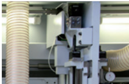
Optional Oberdruck horizontal verstellbar
