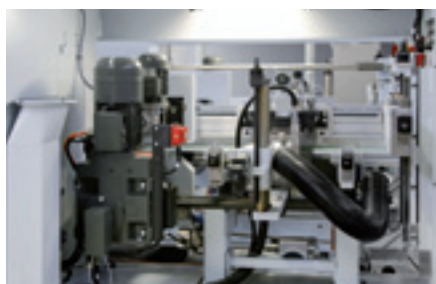
Wahlweise mit Verlängerung zum Anbringen einer Kantenversiegelung oder Faselackierung
