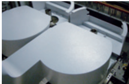
Jeder Motor mit einer an das Werkzeug angepassten Absaughaube
