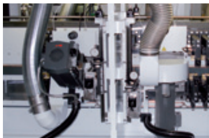
Aggregateführungen mit hochpräziser Einstellvorrichtung und schwenkbaren Hochfrequenzmotoren
