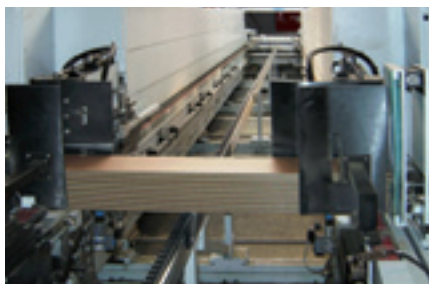
Werkstückmagazin für hohe Takt-Leistung
