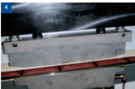
Druck- und Stützsuh bei Laminat für Kettenschutz und exakte Bearbeitung
