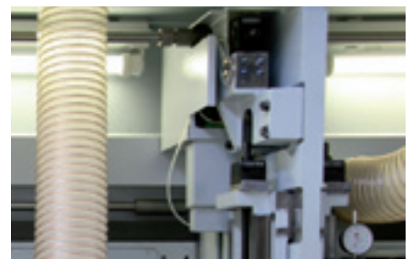
Horizontal verstellbarer Oberdruck mit digitaler Positionsanzeige
