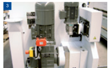
Frequenz- oder servogeregelte Antriebe
