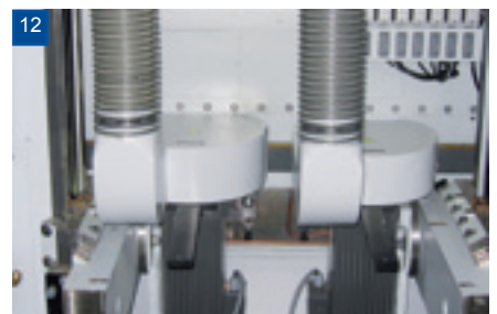
Einzelabsaugung nach oben
