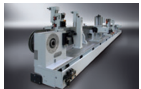
Support-Ständer zur flexiblen Bestückung mit Aggregaten auf dem Maschinenbett
