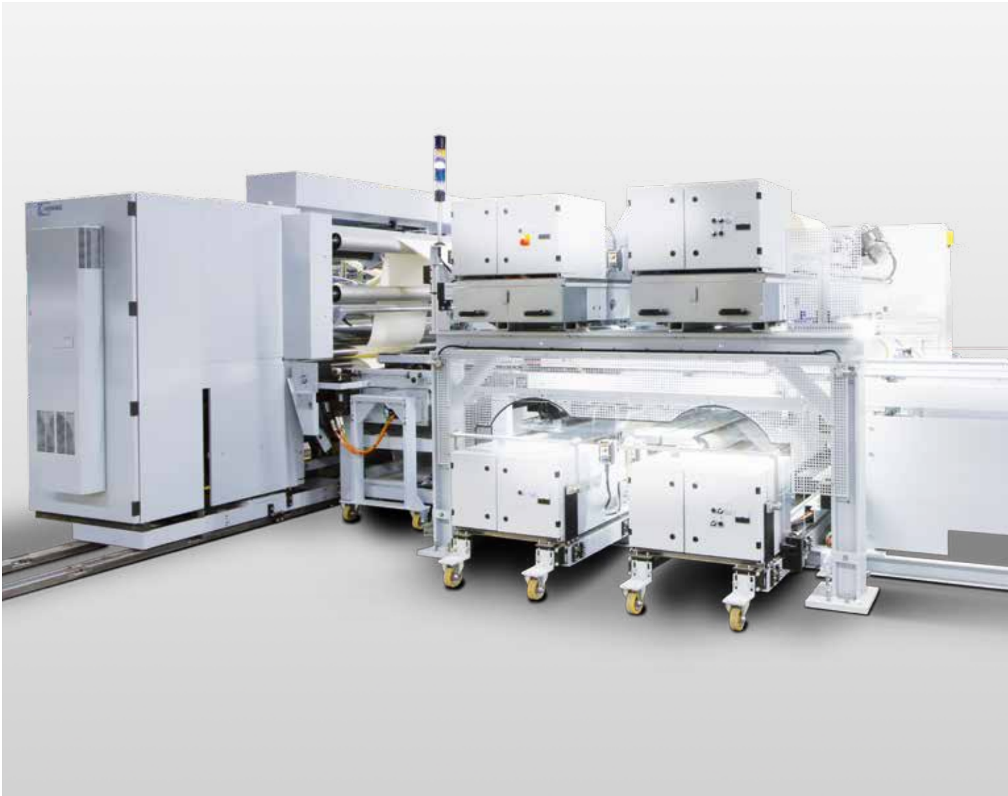
Kaschieranlage LAMTEQ F-300 zur doppelseitigen Beschichtung mit dem reactTec-Verfahren.
