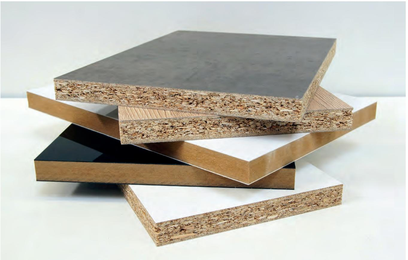
**Hochwertige Möbelteile:** Im Durchlauf kaschierte Werkstoffe. Verklebt mit PUR.
