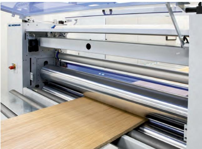
**Kaschierkalander** mit einem Walzenpaar für das Verpressen von belemten Werkstücken mit aufgelegten Beschichtungsstoffen.
