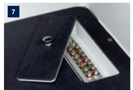
Zugängliche Zentralschmierung an der Maschinenvorderseite
