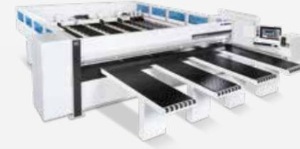
Dépassement de la lame de scie de 65 mm, ou même 80 mm ou 95 mm, sur demande
