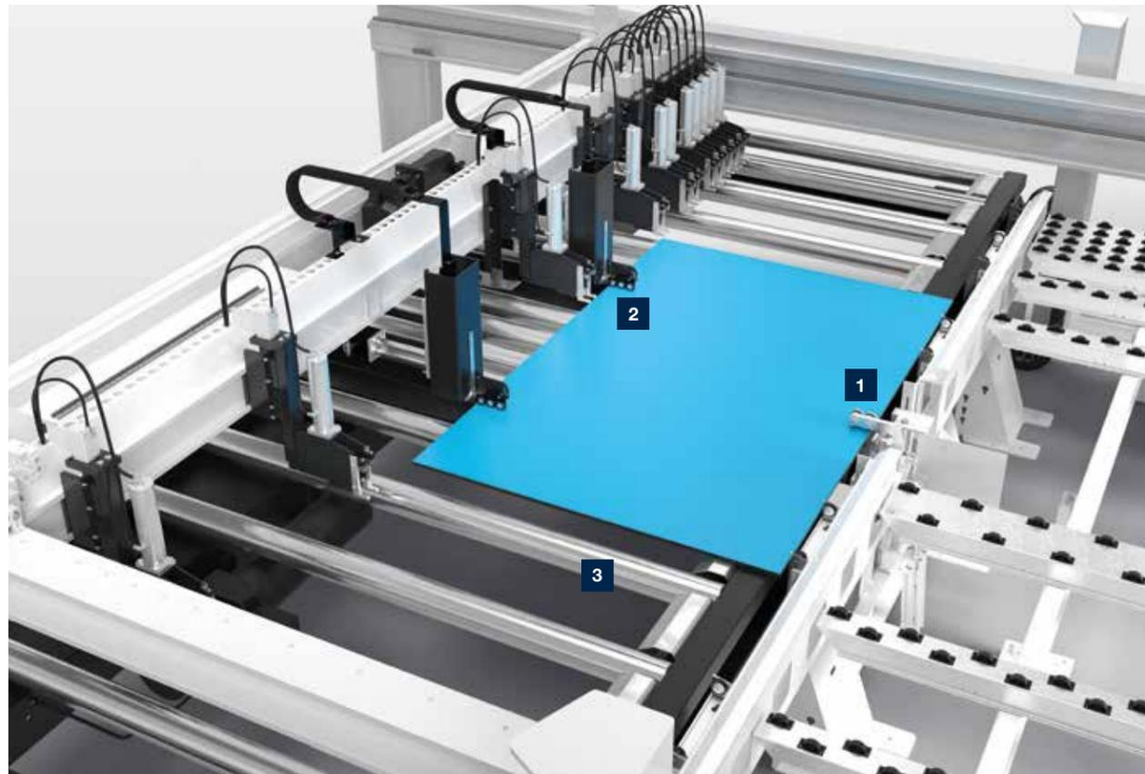
**1 Rückhaltevorrichtung für Dünnpplatten (nur für Hubtischsägen und Winkelanlagen)**
