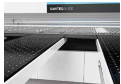
便利なクリーニングフラップ 迅速で便利: 鋸キャリアッジの下の領域にフラップを介して簡単にアクセスできるため、切断廃棄物を簡単に除去または掃除機で掃除できます。
