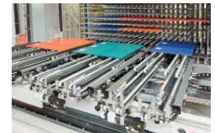
Fahrwagen mit 3+1 Festkante: Erweiterung der Flexibilität durch frei bestimmbare Materialfluss-Strategien.
