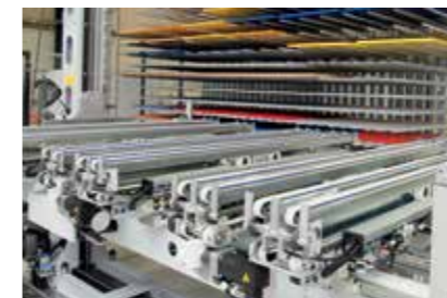
Optimierter Fahrwagen: Deutliche Energieeinsparung durch Gewichtsreduktion und erweitertes Festkantensystem
