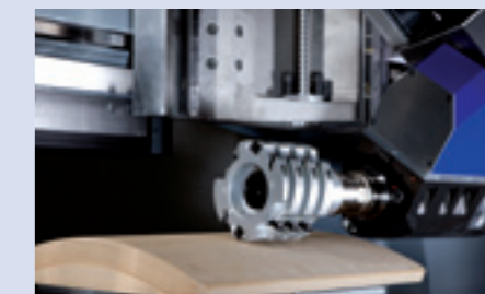
Profilování tvarových dílců se standardním frézovacím nástrojem
