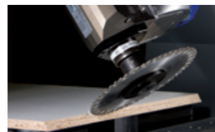
Přesné zkosené řezy bez otřepů a frézování příčné drážky pro napojení desek.
