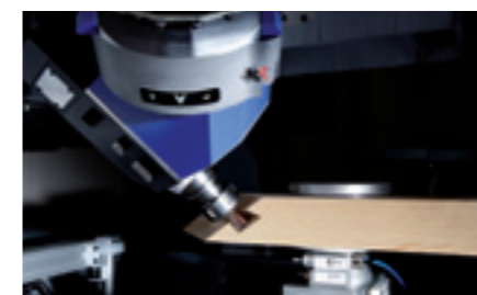
Frézování hřebenového spoje pro příčky a barové konstrukce.
