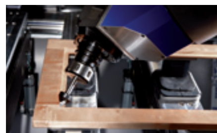
Rohové vybrušení rohu zasklívací lišty
