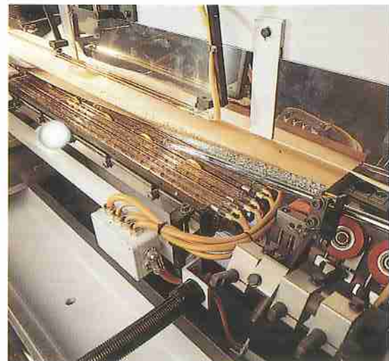
Heizstrahler zur thermischen Aufbereitung des Laminats mit Biegestation und Druckzone.
