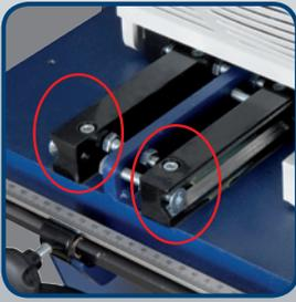
· Das Bohraggregat ist auf gehärteten Prismenführungen mit bewährtem Kugelkontaktsystem gelagert
