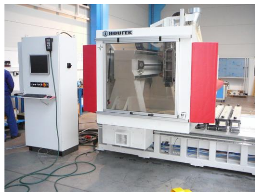
Umístění rozvaděče (standard)
