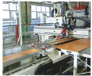
Durch die optimierte Verschachtelung der einzelnen Bauteile in der Rohplatte ergibt sich ein minimaler Verschnitt. Die Fertigungszeiten der einzelnen Bauteile werden kürzer durch das Reduzieren von Wege- und Werkzeugwechselzeiten.
