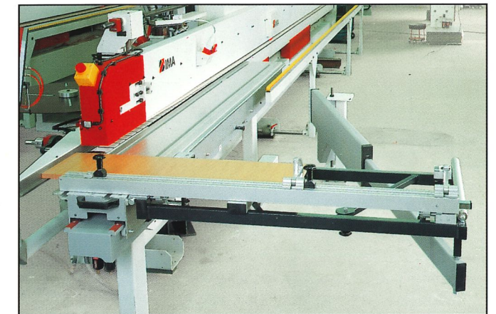
Einschubtisch zur manuellen Zuführung schmaler Werkstücke (Querbearbeitung).
