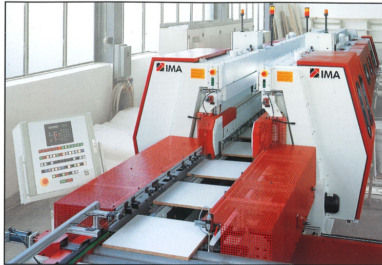
Einlaufsituation COMBIMA II: Werkstückübergabe in einer Ebene (Option 2. Ebene).
