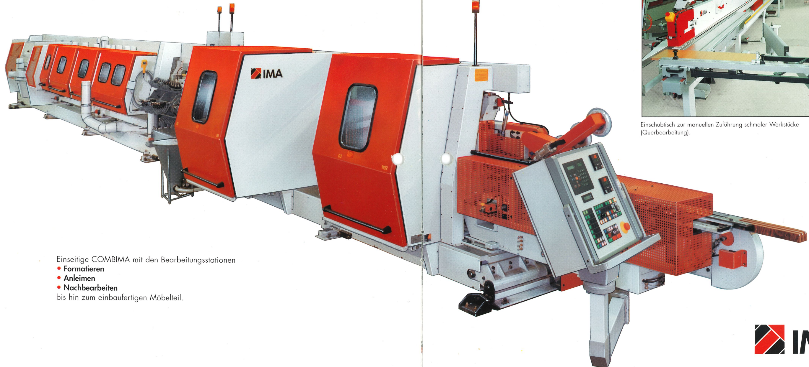
Vakuum-Einschubtisch zum winkeltreuen Einführen unterschiedlich großer Werkstücke.
