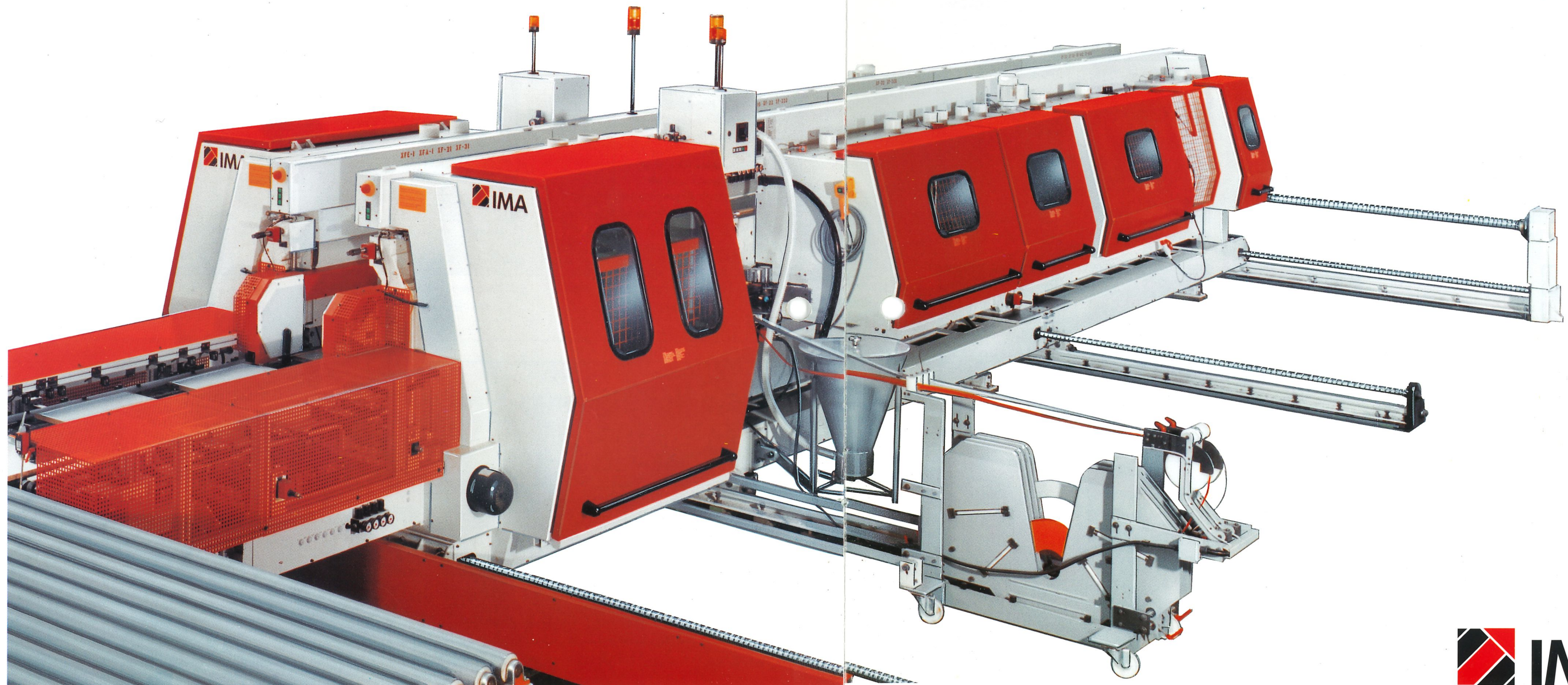
Einlaufsituation COMBIMA II: Werkstückübergabe in einer Ebene (Option 2. Ebene).
