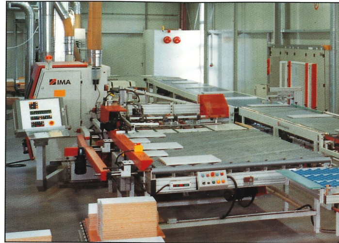
Vakuum-Einschubtisch zum winkeltreuen Einführen unterschiedlich großer Werkstücke.
