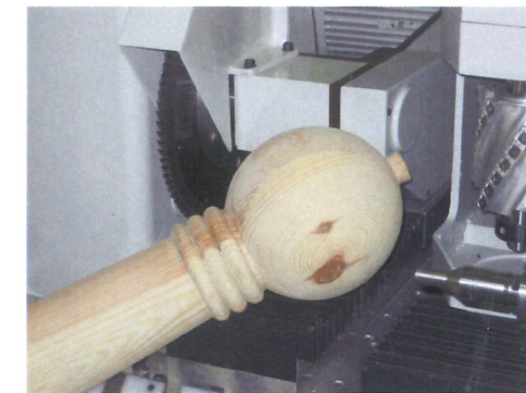
Mechanization of columns with the special saw blade to turn in CNC Mecanización de columnas con el disco de sierra especial para torneado en CNC
