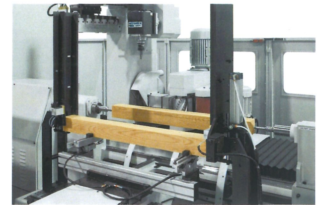
Mechanization of newel posts in automatic cycle up to sq. 140x140 Mecanización de pilares de escalera en ciclo automático hasta cuadrado 140x140
