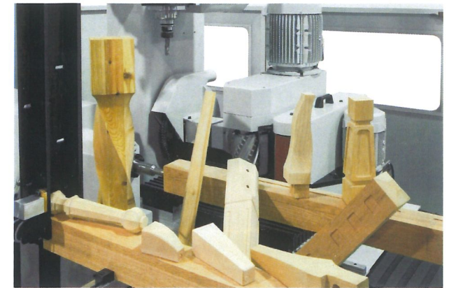
Several type of pieces mechanized in the TMC-1500 Varios tipos de piezas mecanizadas en el TMC-1500
