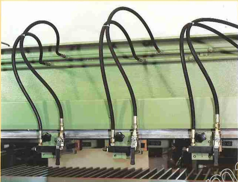
Particolare dei cilindri di spinta orizzontale scorrevoli su apposita piastra, per il loro ottimale posizionamento in relazione alla configurazione del carico.
