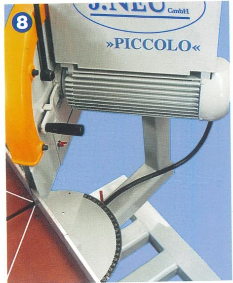
**8** **Detail:** Große, gut ablesbare Gradskala am Gehrungssägetisch (GSE), auf Wunsch mit digitaler Gradanzeige – verstellbarer unterer Sägeschutz.
