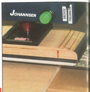
6 Maschinentisch bis zur hinteren Werkstückkante rausziehen
