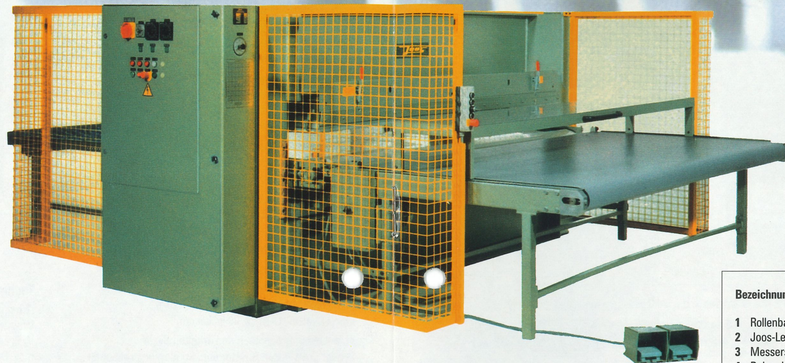
Joos-Durchlauf-Pressen DLP Economic System 2000 (Pat. 512 300) Beschickung von der Längsseite
