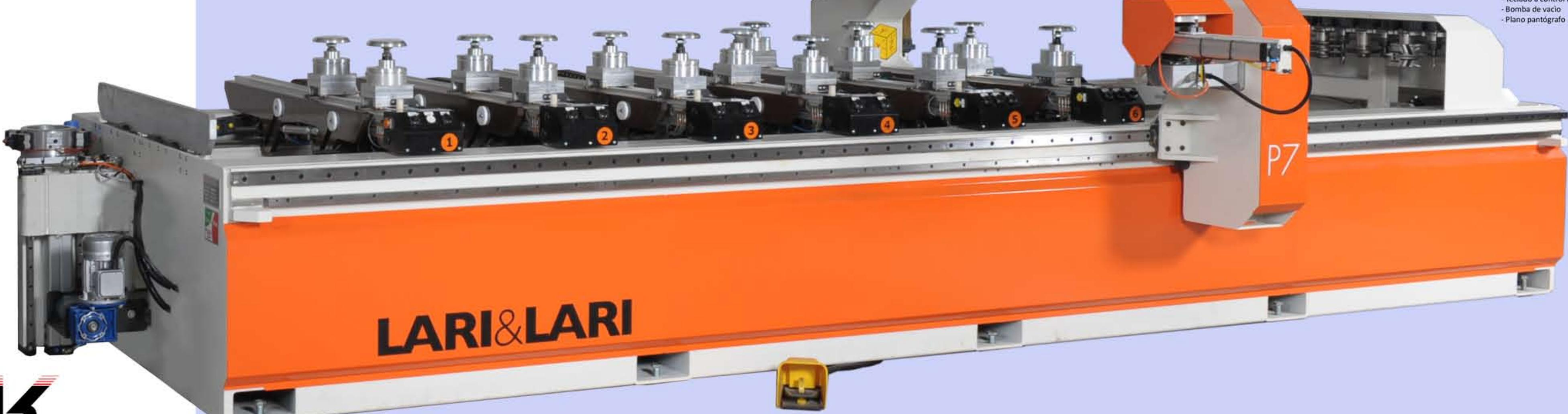
**Centro di lavoro a CN per lavorazione di fresatura, foratura, taglio, profilatura, tenonatura, bedanatura e anubatura su elementi in legno o materiali plastici e compositi.**
