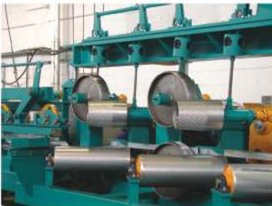
Beschickungsvorrichtungsrullen mit 600 mm Durchmesser Infeed rolls of 600 mm diameter
