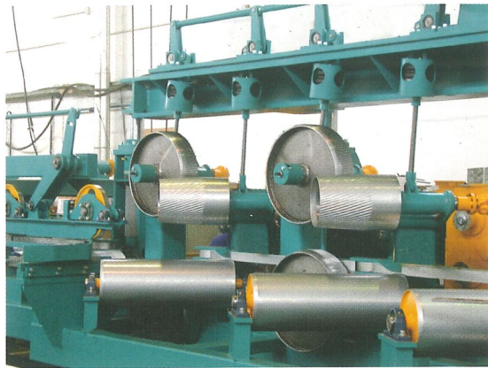
Beschickungsvorrichtungrollen mit 600 mm Durchmesser Infeed rolls with 600 mm diameter
