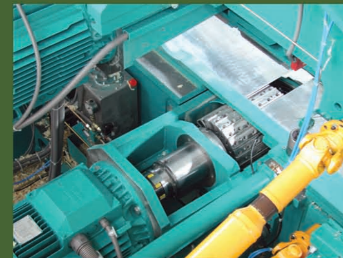
Untere ROTAPLANSPINDEL mit Jointer Bottom ROTAPLAN SPINDLE with jointer
