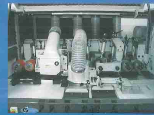
Mesas cromadas. Regulación frontal de los ejes con visualizadores siko. Rodillos motorizados de arrastre en mesa de salida.
