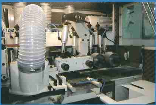
Presión neumática del arrastre. Rodillos de entrada con presión independiente para función de enderezada.
