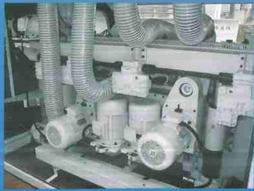
Motores independientes en cada eje. Sistema de transmisión tipo cardan. Doble soporte de columna del montante móvil
