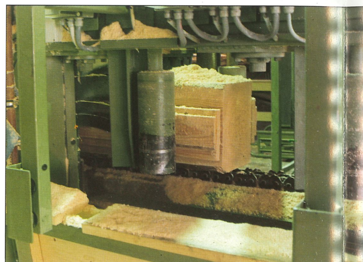
Profilieranlagen – Bearbeiten und Aufteilen des Rundholzes in einem Arbeitsgang im Längsdurchlauf
