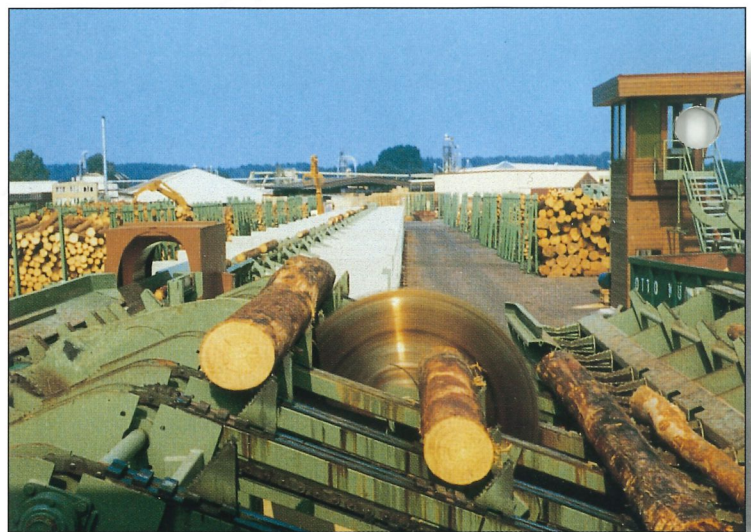
Hochleistungsrundholzplätze mit hoher Taktzahl/min., Ausformung von Schwach- und Starkholz, Sortierplätze für Abschnittsortierung
