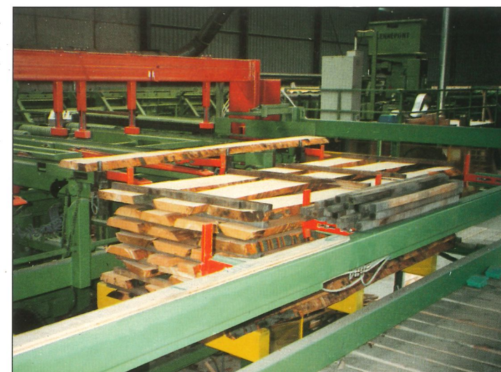
Stapelanlagen – Sondermodelle zur Stapelung von kurzen Palettenbrettern sowie unbesäumter Ware/Blockware
