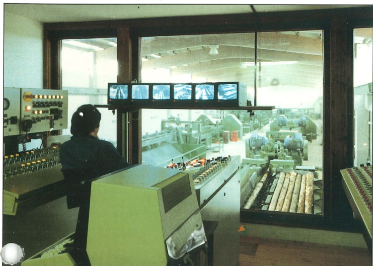
Profilieranlagen – eine Kombination von Profilspanern, Doppelwellenkreissägen und Fräs-Sägeaggregaten
