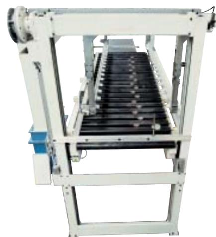
Le piattaforme elevatrici ottimizzano la quota di prelievo/deposito del pannello minimizzando la corsa verticale del braccio portaventose.
