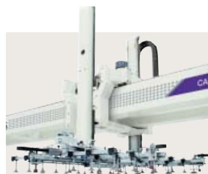
Il braccio porta ventose garantisce una sicura presa del singolo pannello per carichi pesanti. Le numerose ventose ad intervento automatico si adattano alla geometria del pezzo da movimentare.
