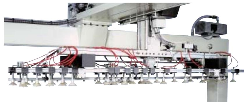
Il gruppo di presa pannelli è costituito da un rigido telaio in alluminio che sostiene le ventose. Il posizionamento delle due file di ventose è gestito automaticamente in funzione della larghezza del pannello.
