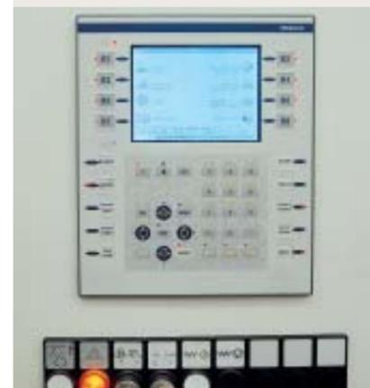
Il controllo elettronico con tastiera e il display grafico permettono un intuitivo utilizzo della macchina nella massima sicurezza operativa.
