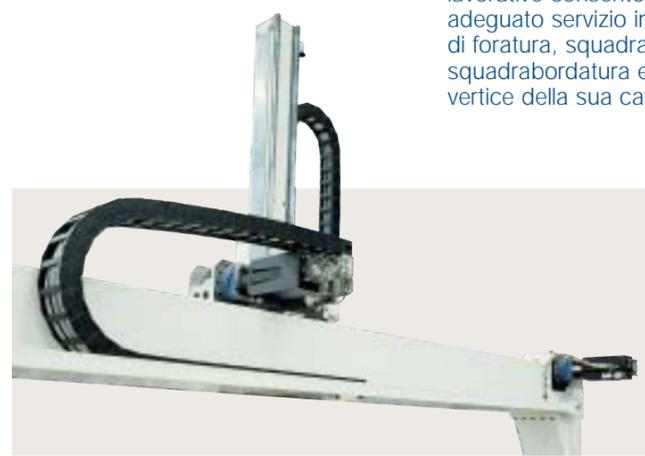
La potente motorizzazione brushless e il particolare progetto di motorizzazione fissa per la traslazione del carro, consentono al sistema di raggiungere facilmente velocità ai vertici della sua categoria.
