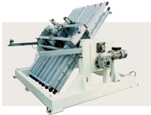
Dispositivi automatici per il ribaltamento del pannello singolo affiancato o in composizione longitudinale.
