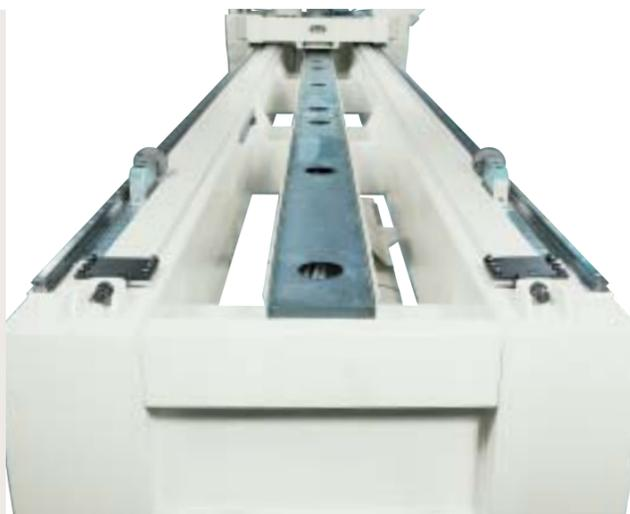
Le guide prismatiche a ricircolo di sfere garantiscono migliore fluidità di movimento orizzontale e verticale. La lubrificazione automatica delle guide assicura affidabilità nel tempo.
