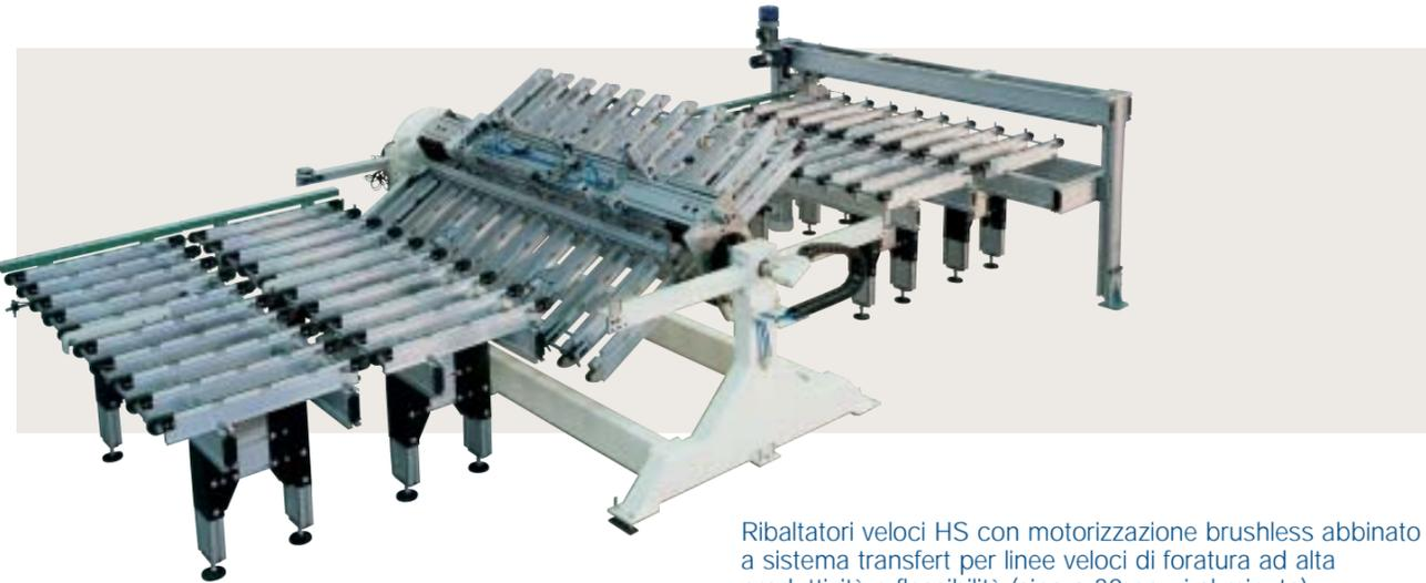
Ribaltatori veloci HS con motorizzazione brushless abbinato a sistema transfert per linee veloci di foratura ad alta produttività e flessibilità (fino a 30 pezzi al minuto).
