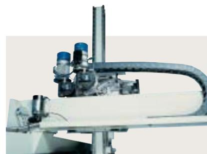
L'azionamento dei motori tramite inverter garantisce fluidità di movimento e grande precisione di posizionamento.
