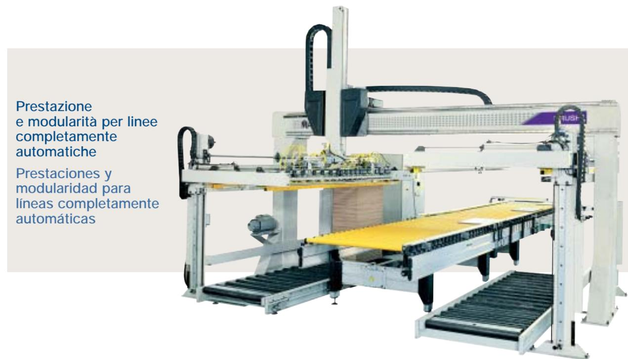
Alimentatore e impilatore a doppia o singola stazione di prelievo o deposito.
