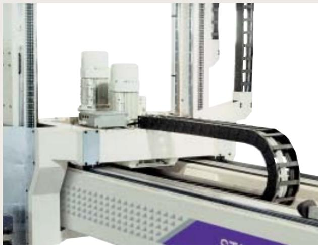
Le due cinghie dentate rinforzate con trecce in acciaio garantiscono massima precisione di posizionamento e ottimi livelli di silenziosità.
