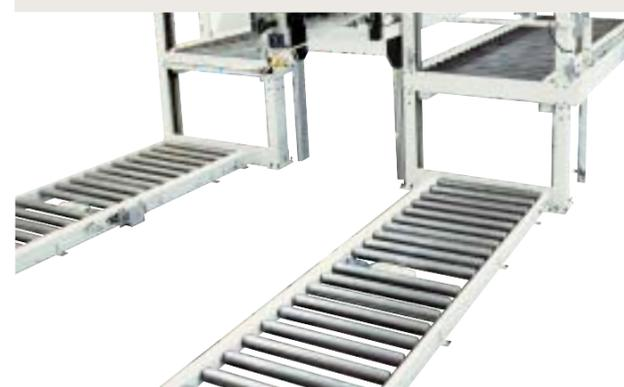
Le rullie motorizzate con inverter garantiscono la necessaria continuità lavorativa con ridotti tempi di set-up.
