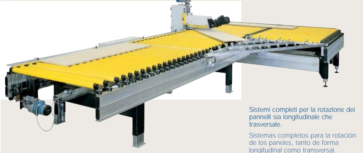
Sistemi completi per la rotazione dei pannelli sia longitudinale che trasversale.
