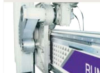
L'utilizzo della cinghia dentata per la trasmissione del moto garantisce la minima rumorosità e massima precisione. Le cinghie rinforzate con fili in acciaio assicurano maggior durata nel tempo.
