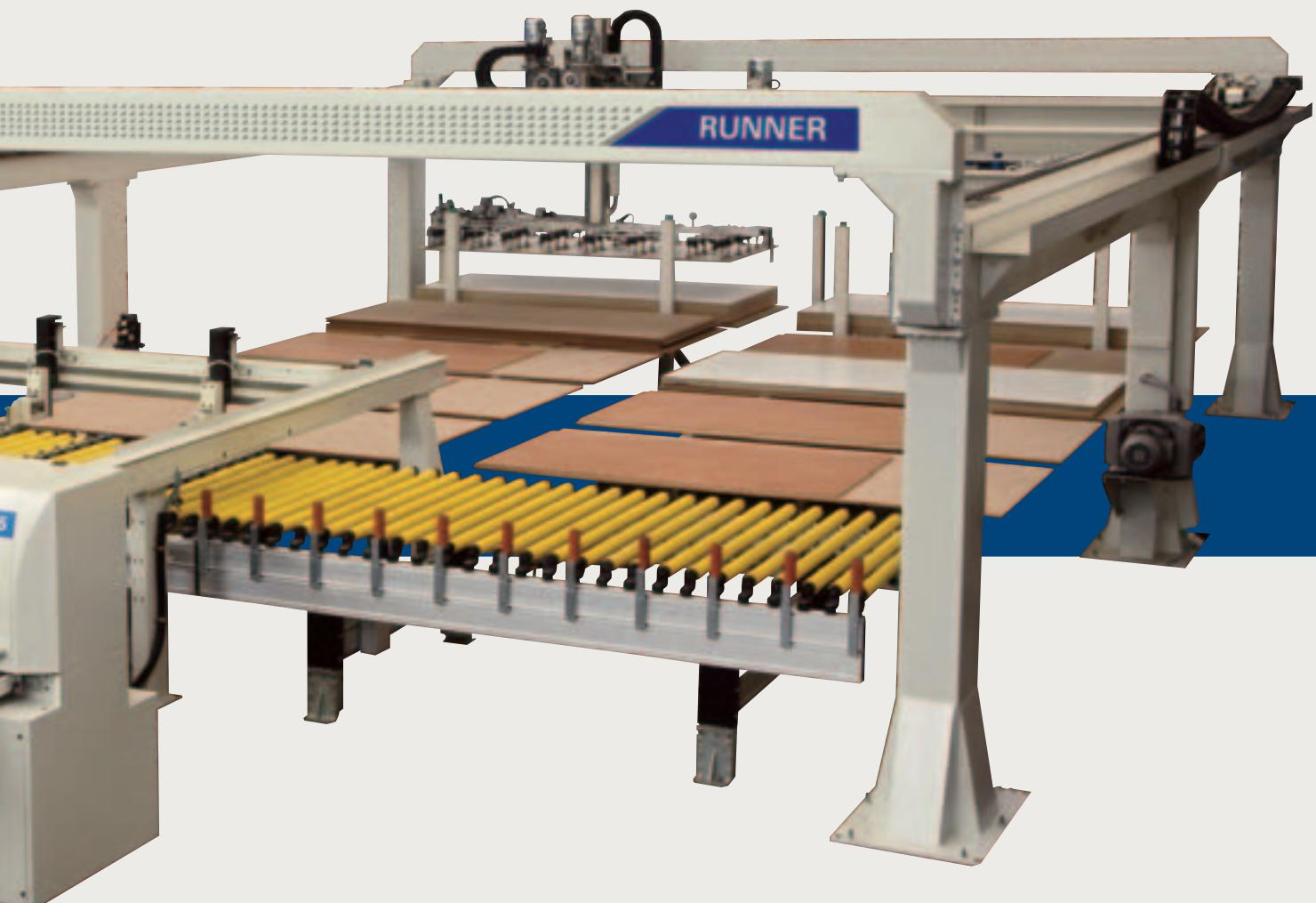
**Magazzino multi-stazione automatico** e ponte di carico a tre assi per alimentazione diretta della sezionatrice.
