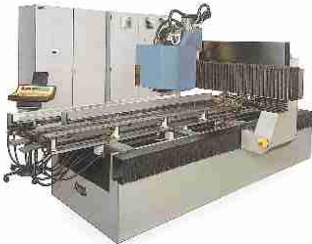
Aluminiumprofil-Fräs- und Bohrautomat
