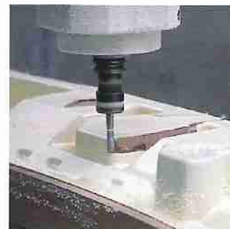
2 Acabado de componentes de materia plástica
