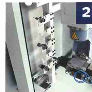
2 Cambio de herramientas Almacén de herramientas linear con 6 unidades
