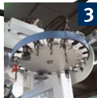
Werkzeugmagazin Werkzeugtrommelmagazin, horizontal, 20 Magazinplätze
