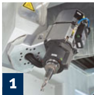
Fräsaggregat Als Standard-Spindel bieten wir die HSK F 63 an
