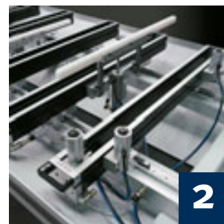
Maschinentisch mit 8 Auflagetraversen, schnellverstellbar
