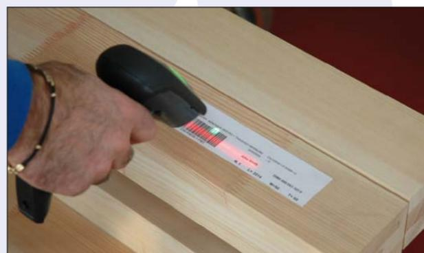
Lettura del codice a barre sul grezzo nel magazzino
