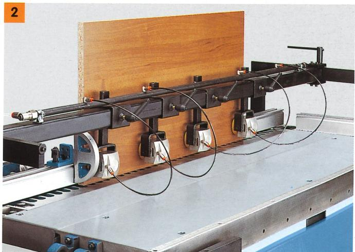
**I** Foratura contro la guida posteriore di un pannello posto in verticale bloccato dai pressatori rotanti a 90°, concetto innovativo di foratura.
