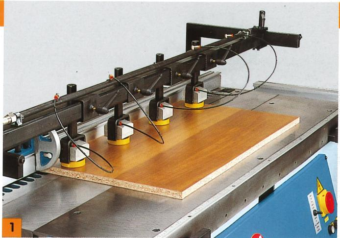
**I** Foratura di un pannello in appoggio sul piano di lavoro, il riferimento fisso rappresentato dal robusto piano della macchina assicura assoluta precisione di assemblaggio con tolleranze centesimali.
