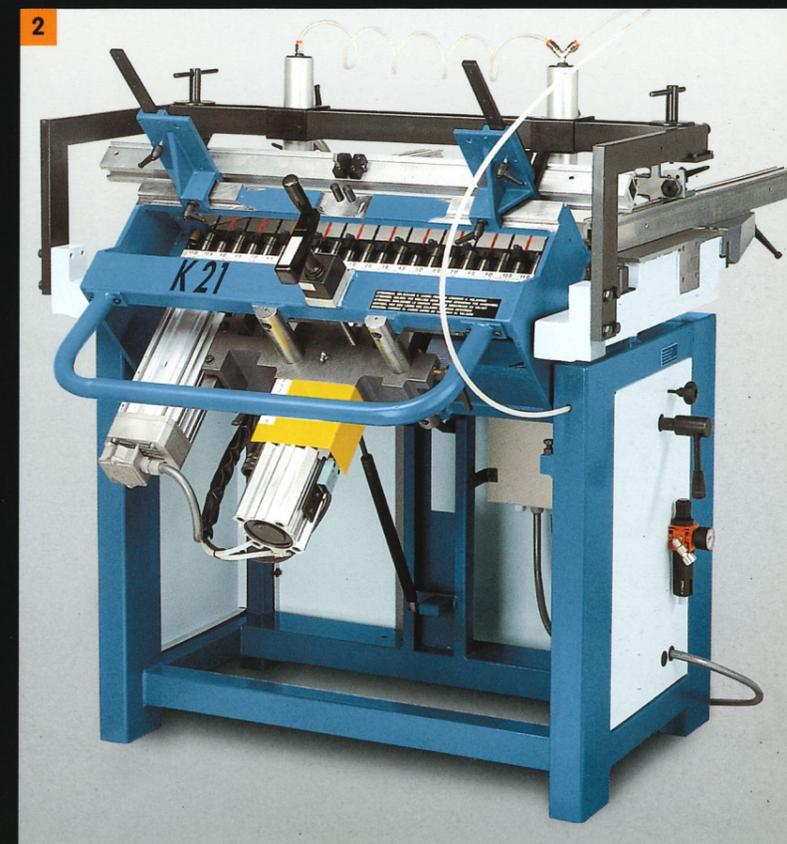
**I** Vista della macchina con testa di foratura a 45° e del particolare dello spostamento parallelo della testa di foratura con un volantino.
