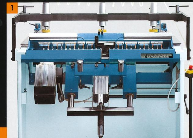
**I** Robuste guide cilindriche assicurano uno scorrimento preciso in fase di foratura. Lo spostamento parallelo della testa di foratura avviene tramite volantino e lettore meccanico decimale.
