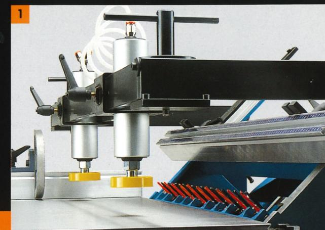
Rotazione a 45° della testa di foratura e del piano ruotante per la esecuzione di forature inclinate. Rotazione pneumatica.
