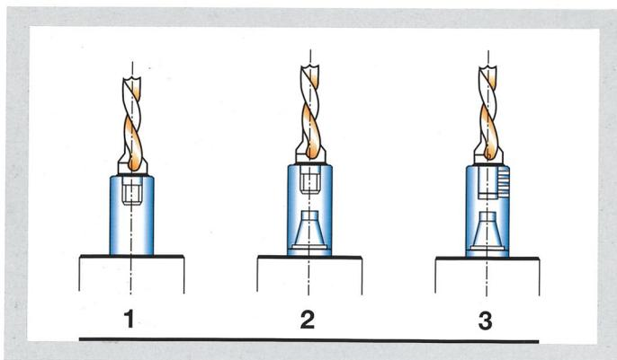
**I** Testa di foratura con mandrino filettato M 10(1), testa di foratura ad attacco rapido con bussola per punta ad attacco filettato M 10(2), testa di foratura ad attacco rapido con bussola per punta a codolo cilindrico diametro 10 mm. (3).
