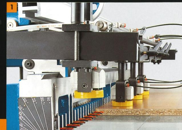
**I** Rotazione a 90° della testa di foratura e del piano rotante per l'esecuzione di fori di assemblaggio sul bordo del pannello.
