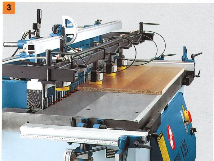
**I** Rotazione della testa di foratura a 90° pneumatica.
