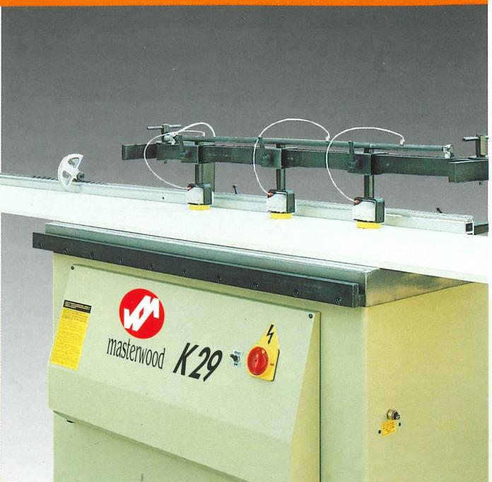
**4** Rotazione a 45 gradi della testa di foratura e del piano ruotante per l'esecuzione di forature inclinate.
