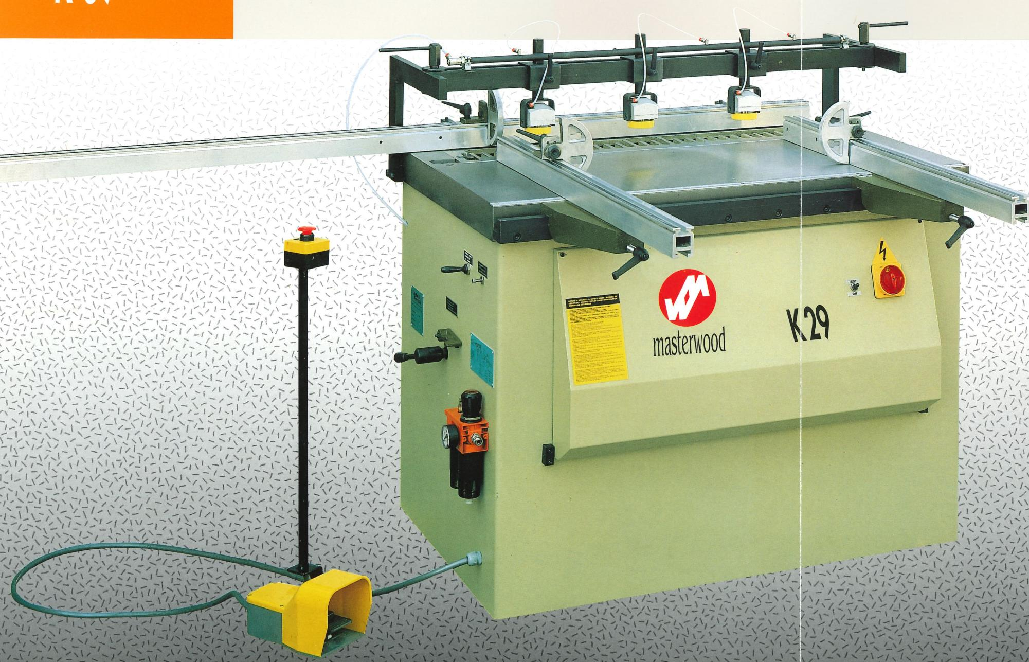
**6** Rotazione a 90 gradi dei cilindri pressatori contro il piano ruotato a 90 gradi per i fori di assemblaggio sul fianco del pannello. Il riferimento fisso rappresentato dal robusto piano macchina assicura assoluta precisione di assemblaggio con tolleranze centesimali.
