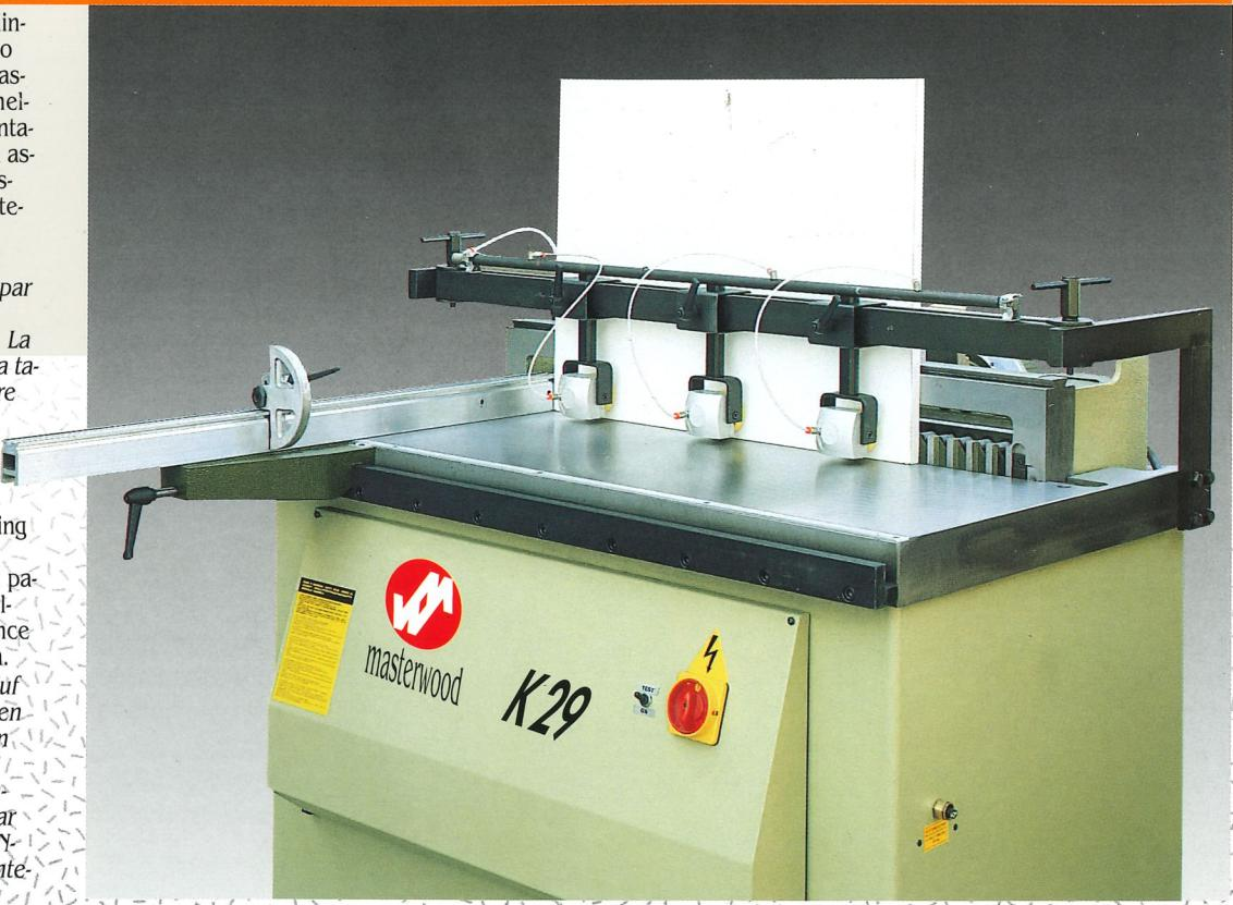
**7** Rotazione a 90 gradi della testa di foratura e del piano ruotante per l'esecuzione di fori di assemblaggio sul bordo del pannello.
