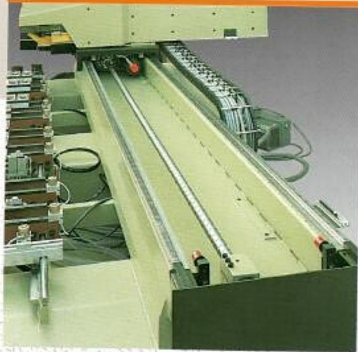
**D** Per esaltare le prestazioni di fresatura ed assicurare spostamenti veloci e precisi, le vie di corsa degli assi controllati sono del tipo lineare, rettificate con pattini a quattro ricircoli di sfere precaricati per elevati momenti torcenti. La vite a ricircolo di sfere dell'asse X, è rettificata con chiocciola ruotante azionata da motore in c.c. o brushless (opzionale).
