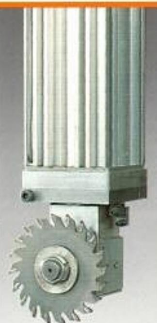
**2** Aggregato fresa verticale con motore da 7,5 Hp, attacco cono morse 2, con velocità di rotazione 18.000 giri 1', regolabile con continuità fino a zero con variazione di frequenza statica da 7kw. gestito dal controllo. Dispositivo manuale di override. Su richiesta, motore da 9hp a 18.000 giri, attacchi speciali LEUCO PS, ISO 30, rotazione utensile destra o sinistra.
