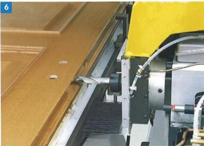
**6** **I** GRUPPO FRESATORE. Elettromandrino da 9 HP, velocità di rotazione dell'utensile da 3000 RPM a 24000 RPM. Vista con utensile in posizione orizzontale.
