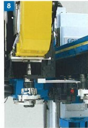
**7** **I** GRUPPO FRESATORE. Vista con utensile in posizione verticale. La rotazione è pneumatica per garantire la massima rapidità. A richiesta può essere fornita la rotazione indexata gestita dal controllo.
