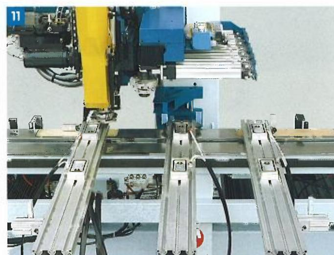
**11** **I** VENTOSE BLOCCAGGIO PEZZI. Dimensioni ridotte (160mm x 60mm) per consentire il bloccaggio anche di pezzi stretti, senza l'impiego di dispositivi speciali. Girevoli, per un perfetto posizionamento in funzione del percorso dell'utensile. Pompa del vuoto standard da 40 m<sup>3</sup>.
