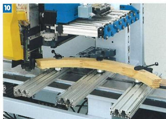
**9** **I** BLOCCAGGIO PEZZI. Tre barre in profilo di alluminio per supportare le morse per il bloccaggio di elementi di finestre ad arco. Bloccaggio interno per permettere la lavorazione esterna, calibratura, profilatura e tenonatura normale o a minizinchen.
