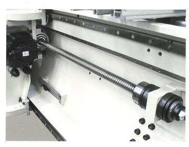
Die Bewegung der Achsen X, Y und Z erfolgt durch bürstenlose Motoren auf Kugelrücklaufschrauben; auf diese Art sind **Beschleunigungen und Abbremsen bis zu 5 m/sec2** mit absoluter Präzision bei der Positionierung möglich. Alle bewegliche Teile werden automatisch geschmiert und sind somit wartungsfrei.
