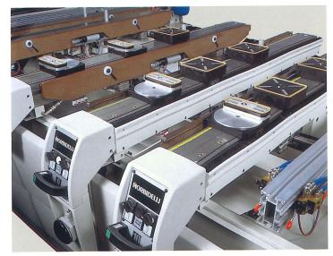
FET (Fast Electronic Table), Die Lösung, um einen Halbtisch der Maschine auszurüsten, während die Maschine auf der anderen Hälfte arbeitet; die Zeiten für diesen Vorgang liegen also innerhalb des Arbeitszyklus der Maschine, der dadurch nie unterbrochen wird.
