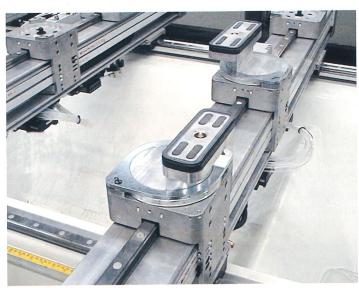
FAT (Full Automatic Table), Ein vollautomatischer Tisch, der mit Halterungen und Saugnäpfen ausgestattet ist und imstande ist, sich in wenigen Sekunden in der für die betreffende Bearbeitung nötige Konfiguration zu positionieren.
