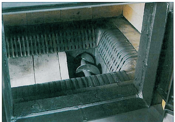
Innenansicht: Schubrechen für Entaschung
