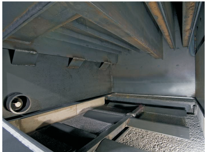
Innenansicht: Schubrechen für Entaschung
