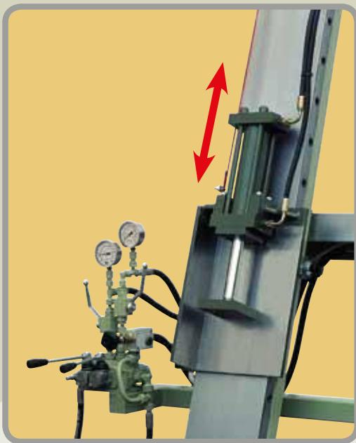
Con i dispositivi di comando è possibile regolare il movimento di tutti i cilindri. I due manometri (uno per i cilindri verticali ed uno per i cilindri orizzontali) servono all'operatore per poter vedere la pressione di lavoro.
