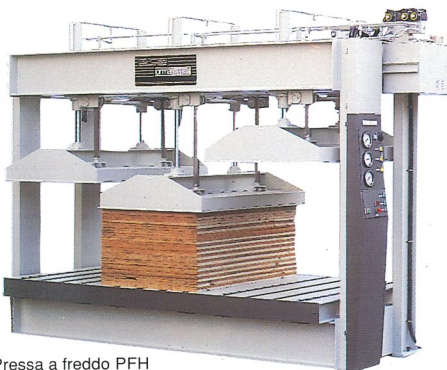
Pressa a freddo PFH PFH heavy cold press Presse a froid PFH Prensa en frio PFH Kaltpresse PFH
