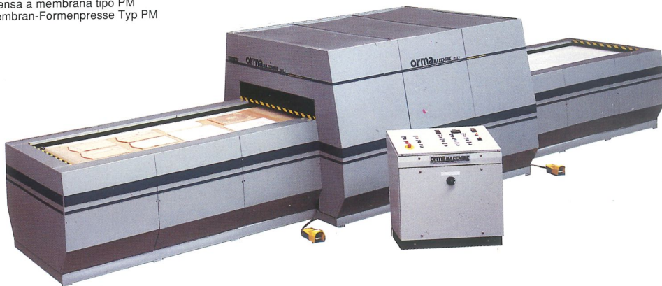
Pressa a membrana a ciclo continuo PM/CA Continuous cycle membrane press type PM/CA Presse a membrane a cycle continuu PM/CA Prensa de membrana a ciclo continuo PM/CA Durchlaufmembran-formpresse PM/CA
