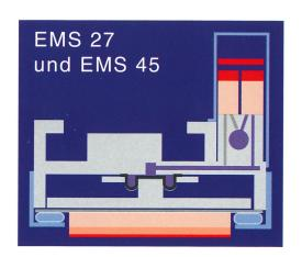
Der OTT-Membranschleifschuh in den Segmentbreiten 27 mm und 45 mm basiert auf modernster Technologie mit platzsparendem Aufbau von pneumatischen Mikroventilen, die über eine serielle Datenübertragung angesteuert werden. Somit kann der Elektronikschuh mit gleichen Abmessungen in die OTT-Breitbandschleifmaschinen integriert werden wie herkömmliche starre Schuhe und Luftschleifschuhe und ist mit diesen natürlich im Tausch wechselbar.
