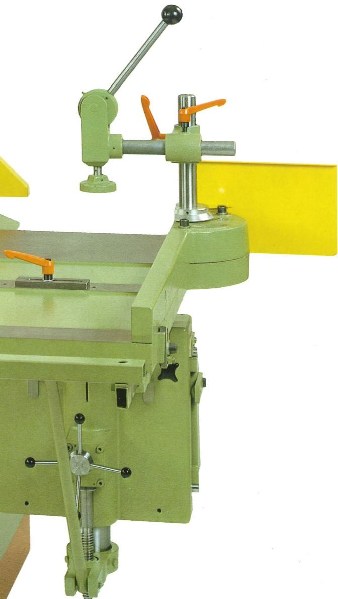
Sonderzubehör: pneumatische Spanneinrichtung
